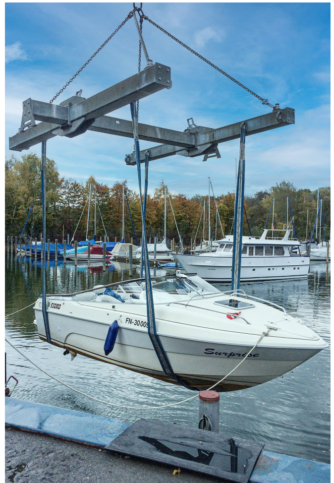
> Beispielbild als Prinzipdarstellung: Alu-Lasttraverse in H-Bauweise mit angehängtem Motorboot
