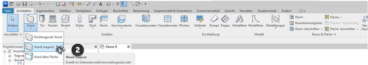
3. Die **kontextabhängige Registerkarte Ändern | Platzieren Wände** wird geöffnet.
